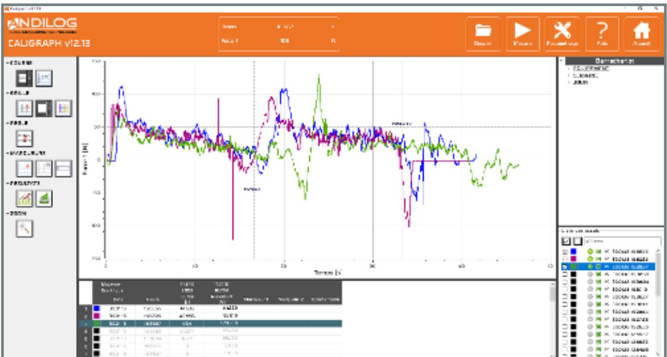
Die Kabellosen WLC Sensoren können über Bluetooth an einen Computer angeschlossen werden, gekoppelt mit der Erfassungs- und Analysesoftware Caligraph. Sie können die Entwicklung Ihrer Kraft- und Drehmomentkurven in Echtzeit überwachen, Ihre Daten aufzeichnen, Ihre Ergebnisse automatisch berechnen und anpassbare Prüfberichte bearbeiten.
