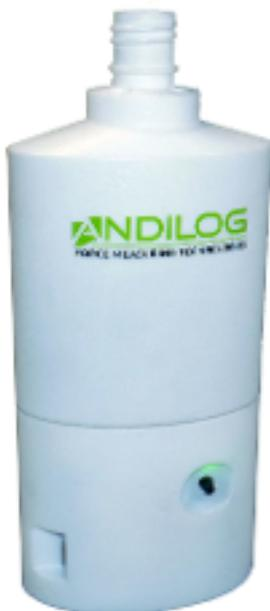
Um die Qualität des Anzugs von Verschlüssen in der Produktion zu kontrollieren, wird meist das Lösemoment an den Flaschen gemessen, nachdem der Verschluss von der Verschleißmaschine eingeschraubt oder eingeschoben wurde.
